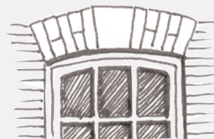
Menuiserie épousant l'arc du linteau de baie
